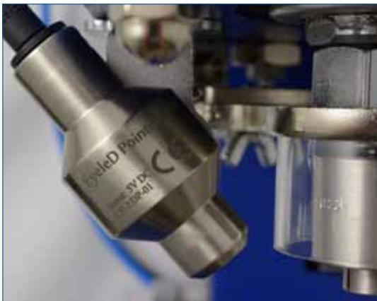
Der EyeLED-Pointer hilft Ihnen bei der Positionierung der Öse. Dieser wird mit einem Batteriecase und einem Netzteil geliefert.
