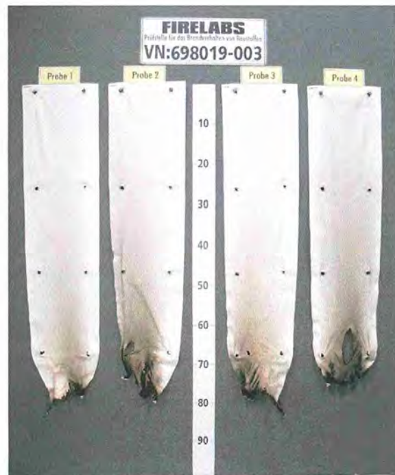
Bild 6 Aussehen des Probekörpers nach dem Brandversuch
